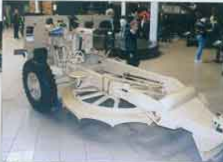
▲ To samo działo; na wewnętrznej stronie prawego ramienia skrzyniowego ogona widać stempel w uchwytach transportowych. Dobrze widoczne jest też siodełko celownicze. Charakterystyczne wystające na hoki uszy w tylnej części ogona amortyzowały ewentualne uderzenia o jaszcz podczas zbyt ciasnych skrętów.
