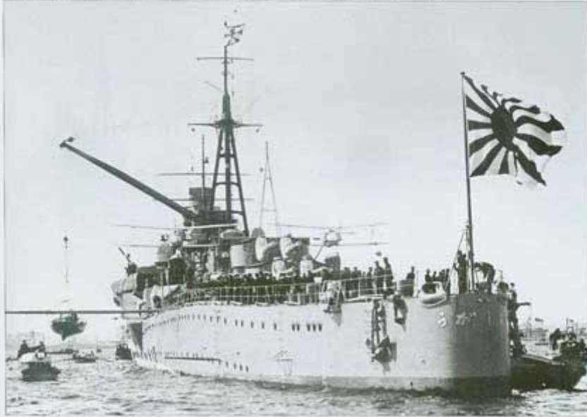
Stern view. Note the curved upper deck line. • Heckansicht. Beachte die geschwundene Oberdecklinie.
