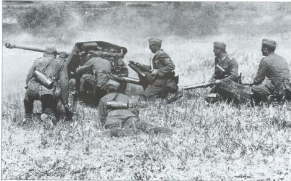
15. Расчет 50-мм противотанковой пушки PaK 38 во время боя. Лето 1941 года, советско-германский фронт. Хорошо видно расположение командира, наводчика, заряжающего и двух подносчиков выстрелов. У казенника видна гильза, экстрактирующаяся после выстрела (АКМ).
